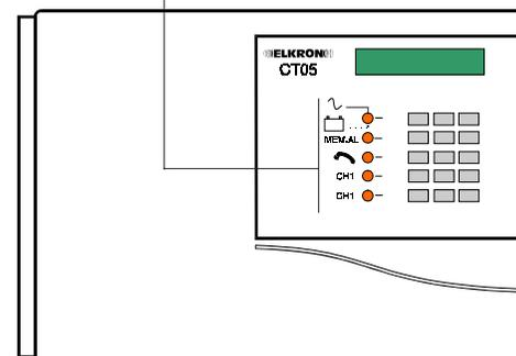
tasti numerici utilizzati per comporre il codice di accesso, i numeri telefonici e per scegliere i valori dei parametri in fase di programmazione
